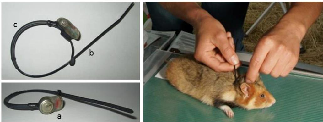
**Abb. 8:** Links: Sender-Halsband der Firma *Biotrack*. Der Sender (a) ist an einem Kabelbinder (b), welcher als Halsband dient, befestigt. Der Kabelbinder und die vom Sender abgehende externe Antenne wird von einem weichen Schlauch umhüllt (c), welcher einerseits das Einschneiden des Senders am Hals des Tiers verhindert, andererseits die Antenne vorm Nagen der Jungtiere schützen soll. Rechts: Besenderung eines Feldhamsterweibchens mit einem Senderhalsband.
