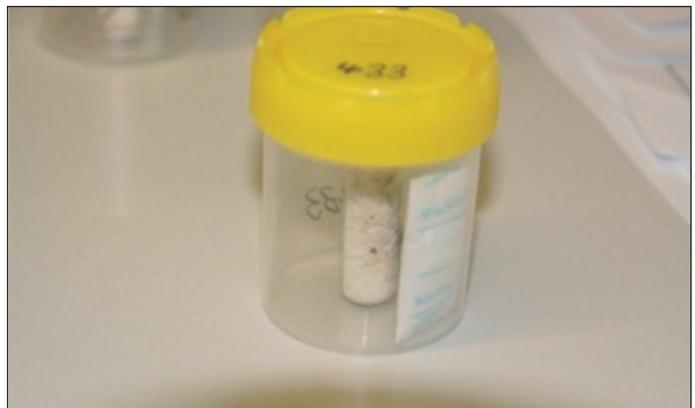
**Abb. 3** Verwendetes Probengefäß mit Nagel und Silica Gel und exemplarisch eine eingebrachte Haarprobe.
